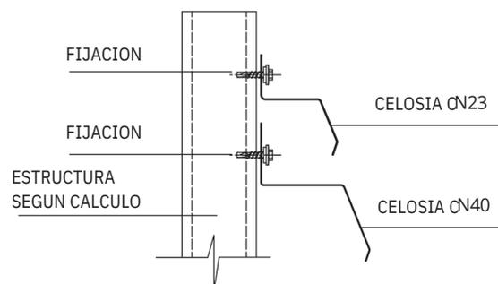
En caso de requerimiento de la obra, puede la Celosía CN-23 fijarse directamente a la estructura, eliminando de esta forma el uso de tensores.
